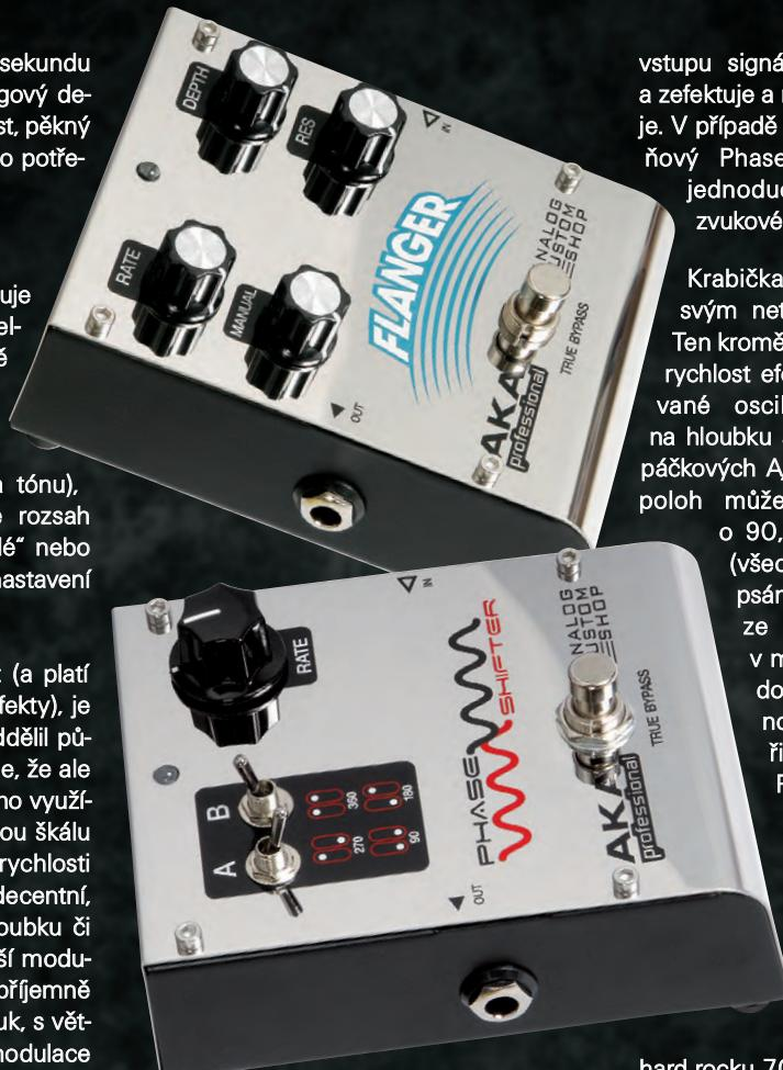
modulaci připomínající rozladování, jež dodá další rozměr vašemu kytarovému tónu. Pro nastavení slouží čtveřice potenciometrů. Rate určuje rychlosť modulace, Depth zajišťuje vyvážení mezi čistým a zefektovaným signálem, Manual nastavuje střední frekvenci rozsahu filtru, a nakonec Res nastavuje rezonanci (tedy kolik signálu se vrací zpět na vstup).
